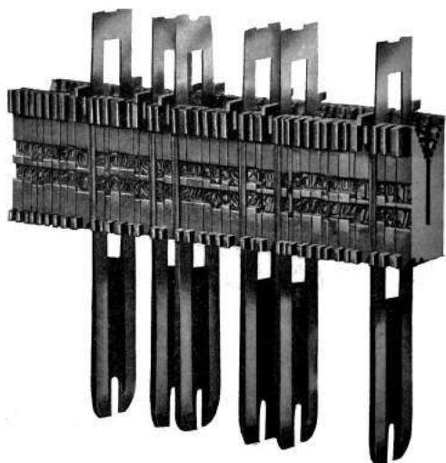
Imagem 7 - conjunto de matrizes e automáticos que forma o molde do lingote.
