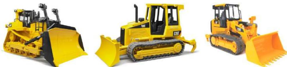
**Figuras 26, 27 e 28. Bulldozer, à esquerda; trator de esteiras, no meio; e carregadeira de esteiras, à direita. Retiradas da internet<sup>38</sup>.**
